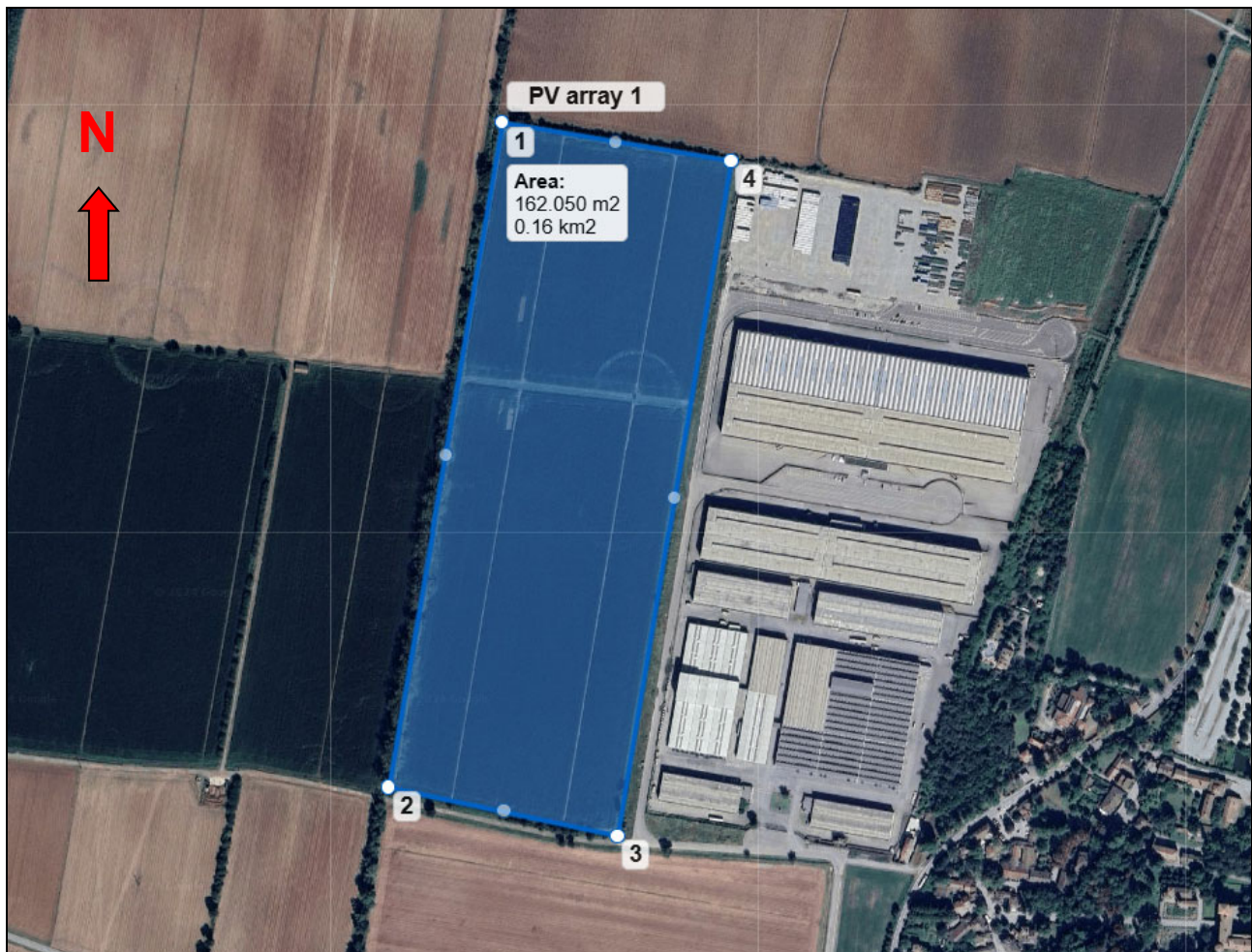
Figura 29 – Modellazione, su mappa satellitare, dell'array dell'impianto fotovoltaico.
